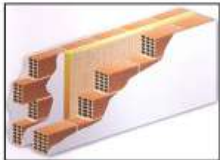
murature in laterizio con isolamento intercapedine
