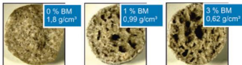
Figura 18: Aggregato leggero prodotto con l'aggiunta di diverse quantità di agenti espandenti.
