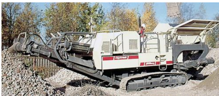
Figura 17: Impianto mobile di trattamento dei rifiuti inerti, dotato di un vaglio, di un frantoio ad urto di un nastro magnetico per la separazione della frazione metallica. [Fonte: www.aufbaukoernungen.de/ziele.html ]
