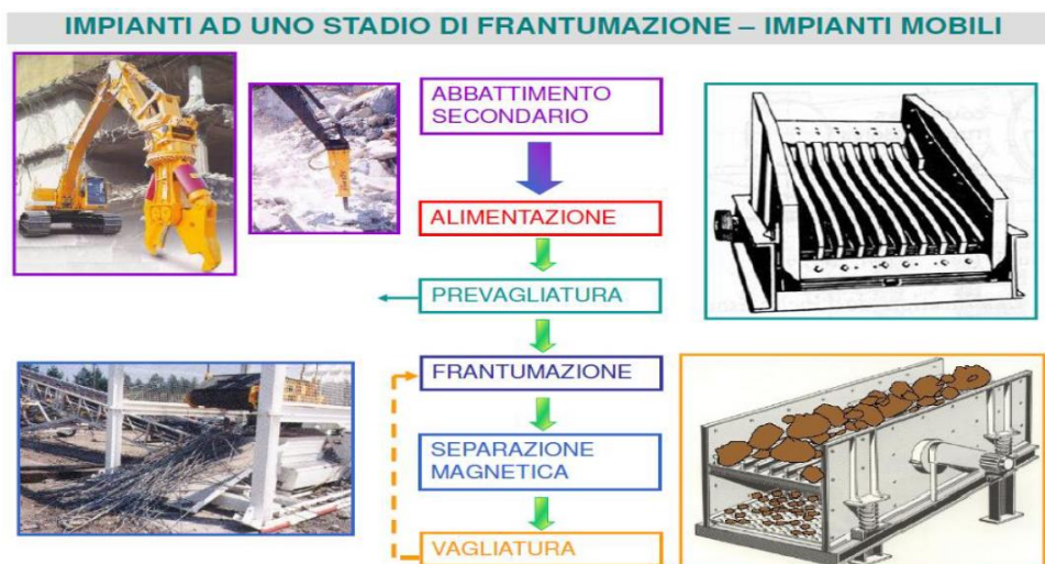
Figura 14: Schema di flusso degli impianti mobili tradizionali. [Fonte: Diotti A., Baronio S. (2018), "Indicazioni e criteri per l'utilizzo degli aggregati riciclati nel settore edile, stradale e ambientale", Rapporto Finale Collaborazione tra l'Associazione Regionale dei Costruttori Edili Lombardi (ANCE Lombardia) e l'Università degli Studi di Brescia]
